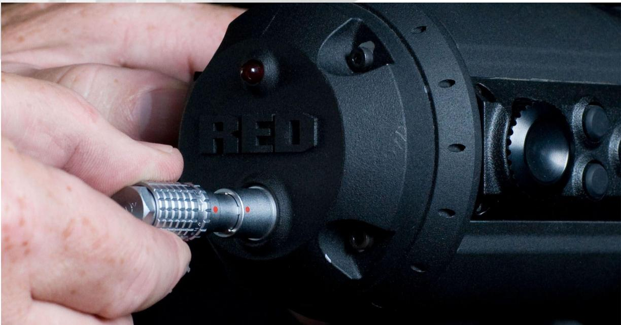
Los cables del LCD y el Visor de RED son intercambiables; pero las salidas no lo son. El visor debe conectarse a la salida superior y el LCD a la inferior.
