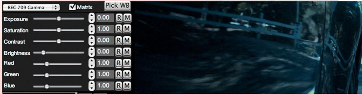
RED ALERT! Puede leer los metadatos de cámara para cada parámetro. Los valores pueden cambiarse desplazando el menú deslizante o introduciendo un valor numérico. “Clickeando” en la R, reseteara el valor al predeterminado. Seleccionando la M, restaurara los valores almacenados en los metadatos de la cámara. Seleccionando la opción GRADE volverá todos valores a los usados en la corrección de color
