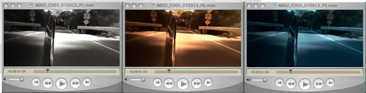
La imagen debe ser mostrada usando un espacio de color REC 709, lineal o una variedad de log. Si el Matrix está sin seleccionar y el display es lineal, los datos que saldrán en pantalla, representaran la respuesta nativa lineal del sensor Mysterium™ sin ningún proceso de color o corrección de gama aplicada. Para la mayoría de aplicaciones para televisión, seleccionar REC 709. Para efectos especiales selecciona Linear o para D.I, una Log.
