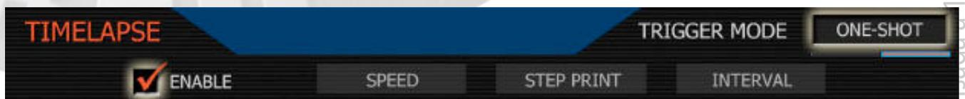
**Enable:** Después de realizar algún ajuste en el menú de Timelapse, selecciona el cajetín "Enable" y activar así la grabación en este modo. El entorno grafico indicara cambiando en la parte superior de la imagen el numero de fps por las letras TL, y el nivel de sonido quedara sustituido por la palabra TIMELAPSE.
